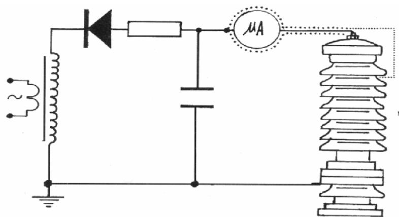
图 7b 排除试品  $C_X$  表面影响接线图
